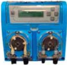
Material cuerpo bomba: PP color azul - Tubo de conexión: 4 x 6 mm - Material tubo peristáltico: santopreno y silicona - Dimensiones: 177 x 171 x 132 mm - Caudal deterg.: 3-4,5 l/h (1,5 bar) - Caudal abrill.: 1,2-2,1/h (2,5 bar) - Presión máx. deterg.: 1,5 bar - Presión máx. abrill.: 2,5 bar - Alimentación: 230 Vac - 50/60 Hz - Código venta:
