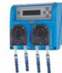
Equipo individual - Dosis programable - Material: Plástico ABS - Nº Bombas: 2 - Caudal: 20 l/h - Alimentación: 110-230 VCA - Cable de corriente y señal 5m - Señales entrada 24-220v - Conexión: tubo 8 x 12 mm - Presión agua: 1-2 bar - Visor: LCD - Zumbador alarma nivel - Dimensiones: 177 x 171 x 132 mm - Peso: 1,5 kg -
