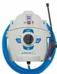
Conexión a la red de agua - Presión de trabajo: 1,5 a 6 bar - Dosifica 2 productos - Tª máx 60 °C - Caudal: 12-16 l/min - Espumado y lavado - Manguera calidad alimentaria 15 m - Pistola pulverizado/aclarado - Accesorio espumador -
