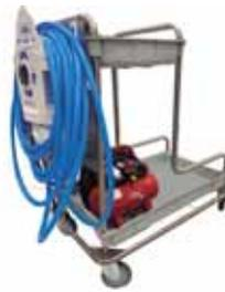
Equipo - Aire comprimido - Conexión a la red de agua - Equipo + Carro móvil + Compresor - Dosifica 2 productos - Rango temperatura: 25 - 45 °C - Presión aire: 2-6 bar - Presión de trabajo: 1,5 a 6 bar - Caudal: 4-8,5 l/min - Espumado y lavado - Manguera calidad alimentaria 15 m - Lanza espumadora/pulverizadora - Carro acero
